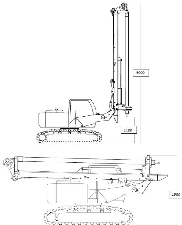
**RP 25rg pilota montada en excavadora**
